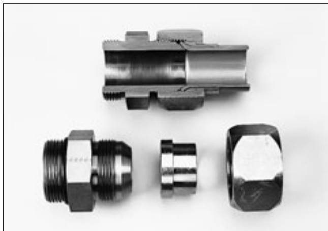
Abbildung C1 – Triple-Lok®-Verschraubungskomponenten (Verschraubungskörper mit O-Ring, Hülse und Überwurfmutter) und Ausschnitt einer zusammengebauten Triple-Lok®-Verschraubung.
